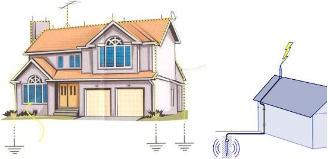
Şekil 3.2: Bina paratoner tesisi
