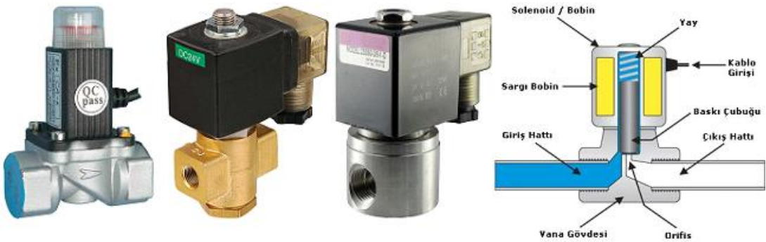
Resim 6.7: Çeşitli selenoidler ve iç yapısı
