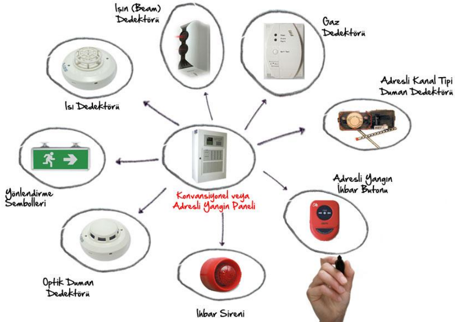
Resim 4.1-b: Yangın alarm sistem malzemeleri
