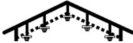
Şekil 3.20: Dedektörün eğimli ve yüksek yerlerde yerleşimi
