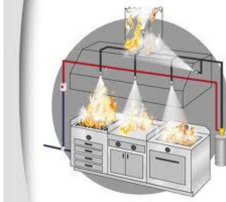
Şekil 3.6: Davlumbaz yangın söndürme sistemi
